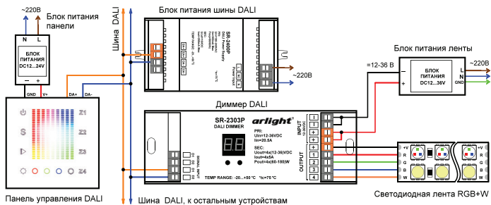
Рис.1. Схема подключения диммера на примере светодиодной ленты RGB+W.
