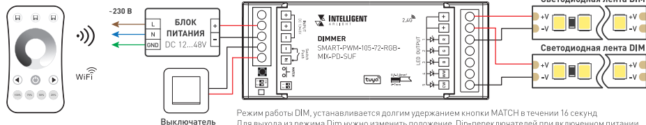
Рис. 1. Схемы подключения диммера SMART-PWM-105-72-RGB-MIX-PD-SUF
